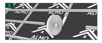
Ein weiterer Bahnenstreifen sollte mit 10-15cm Überlappung angebracht werden (*Bild 4*). Um die Montage der Dachbahn effektiv zu gestalten, Zugluft zu vermeiden und die Überlappungen wasserdicht zu halten, verwenden Sie die mit der Bahn integrierten Klebestreifen, die miteinander verklebt werden. Die Außentemperatur darf während der Verklebung nicht unter +5 °C liegen und die Dachbahn wie auch die Klebestreifen müssen bei der Verarbeitung sauber und trocken sein.
